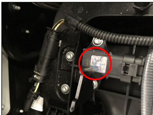
3. Boost pressure sensor „top“
