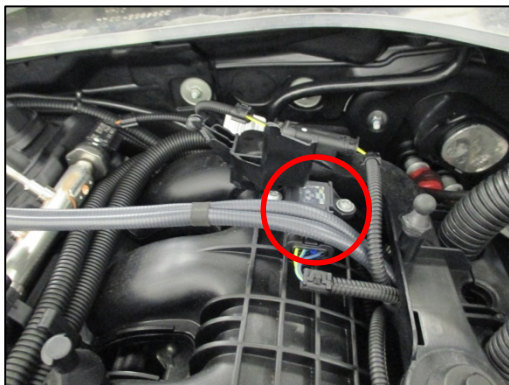
3. Boost pressure sensor „top“
